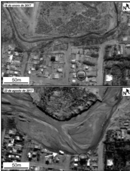
Figura 9. Modificación del ancho del arroyo del Km 8 en la posición aguas abajo de la cantera de áridos. El círculo en ambas fotografías es en una vivienda que se encontraba a 71 m del margen del arroyo y que quedó allí tras el evento extremo. Cabe destacar la incorporación de una construcción de cemento (flecha) dentro del cauce. Fuente: elaboración propia sobre imagen de Google Earth™.
